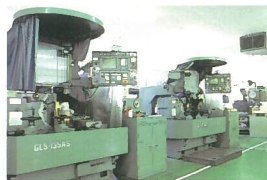
NC光学投影成形研削盤(アマダマシンツール・GLS-135AS)
