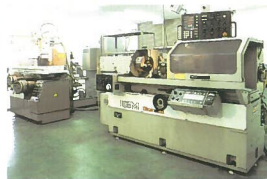
NC内面研削盤(岡本工作・IGM2M)
