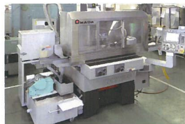
NC平面研削盤(アマダマシンツール・TECHSTER-A1)
